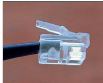
Detalle del típico conector LocoNet "western macho".
