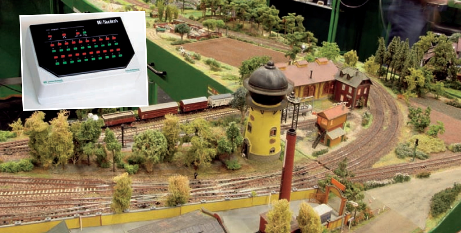
IB-Switch Teclado para 40 accesorios con capacidad para almacenar secuencias de conmutación de accesorios (Trayectos o Itinerarios). Maqueta modular N del Club Modulbau-Team Köln-Bonn.
