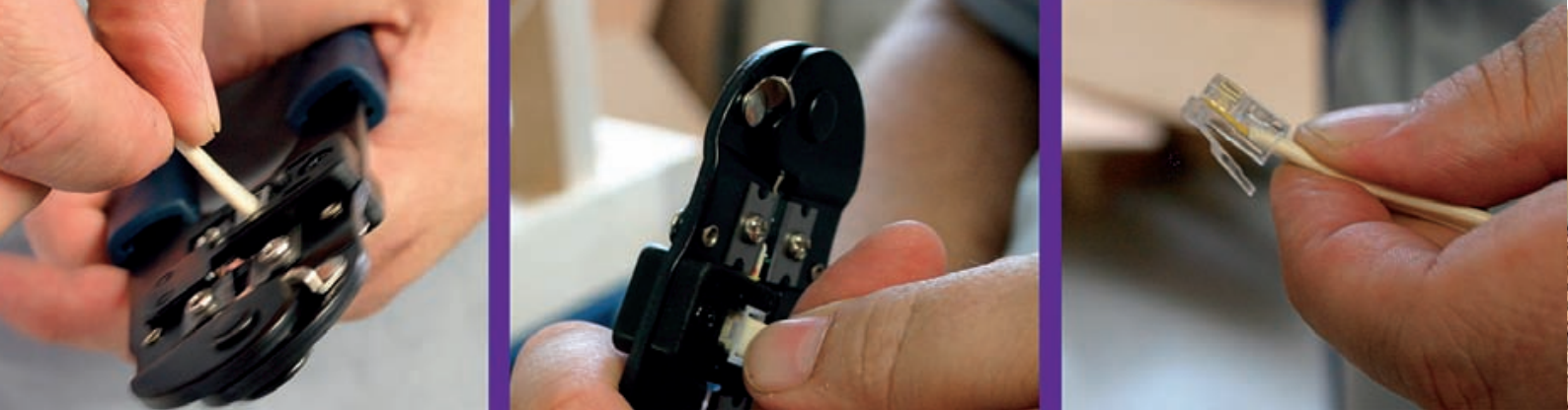
Montaje de un cable para el bus LocoNet. Debajo, vista lateral de la Intellibox con la conexión para el bus I2C.
