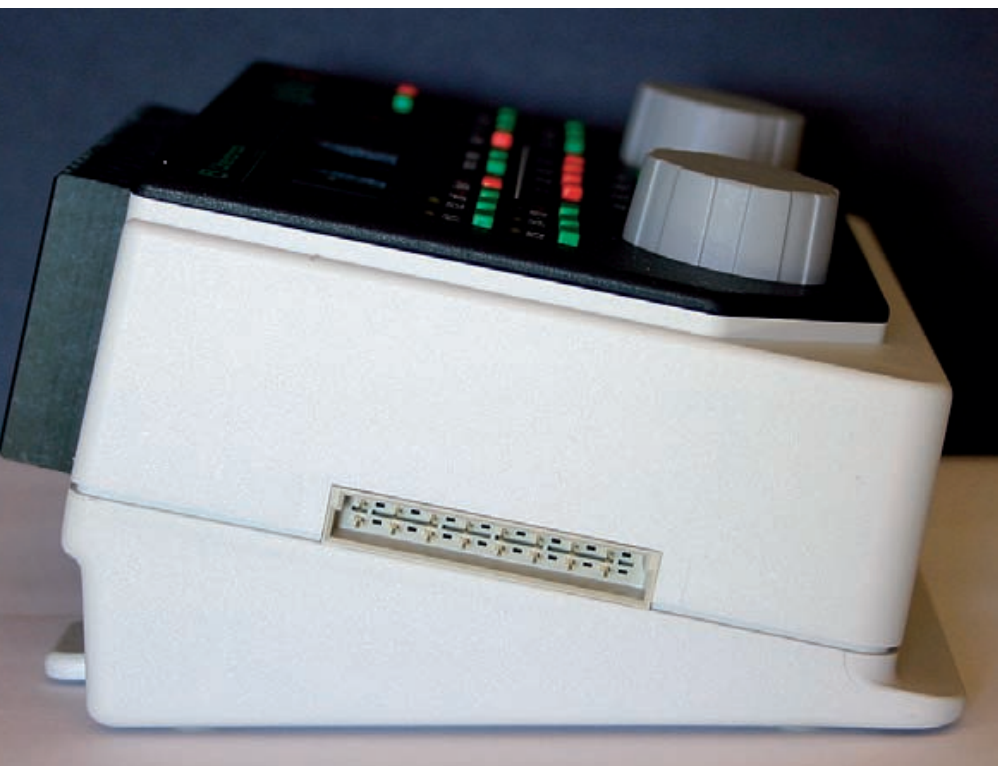
Montaje de un cable para el bus LocoNet. Debajo, vista lateral de la Intellibox con la conexión para el bus I2C.
