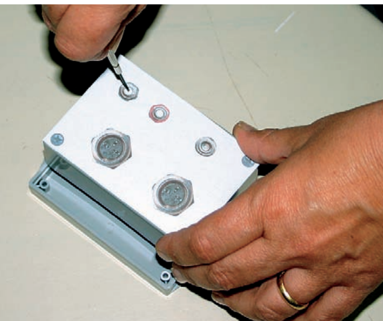
Después de prepararnos una plantilla con la representación de los conectores procedemos a marcar el centro de cada uno de ellos para facilitar el taladrado del agujero necesario.
